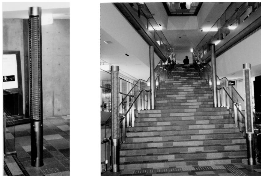
図 7.3.3.2 大階段に設置されたポール型のスピーカ
